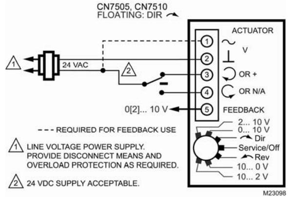
图11. CN7505/CN7510 (浮点控制模式)
