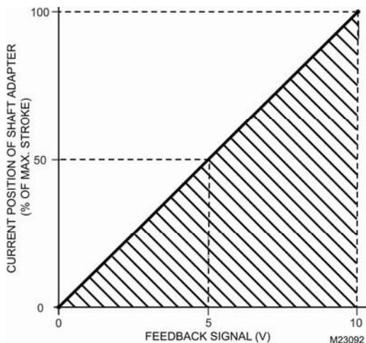
图4. 反馈信号取决于导杆的当前位置 (以0...10 V输出为例)
